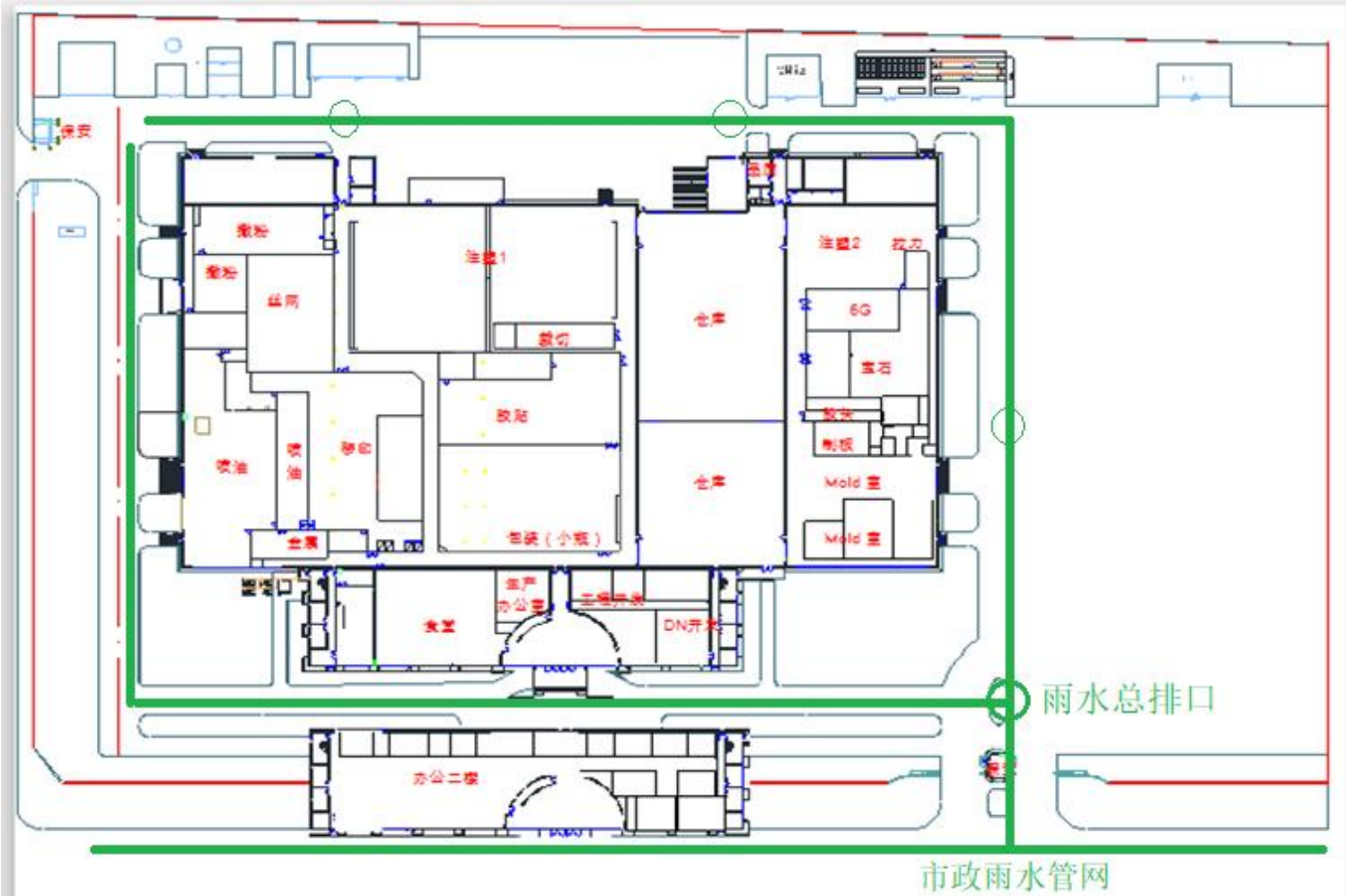
附图 5：厂区雨水管线分布图
