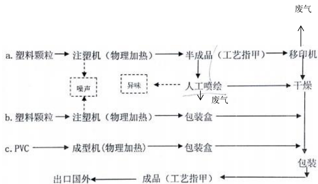
图 2-2 全厂工艺流程图
