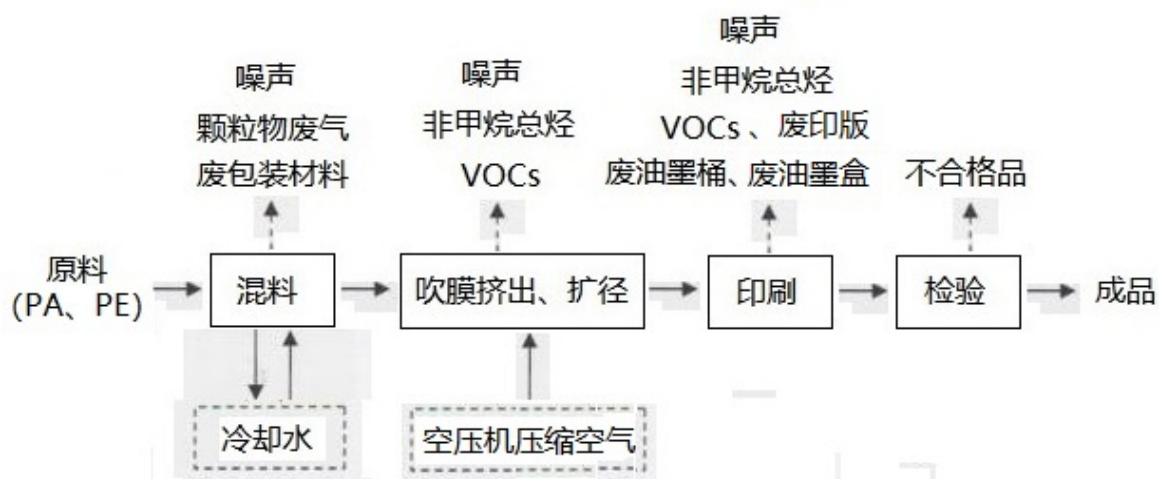
图 2-2 工艺流程及产物环节示意图
